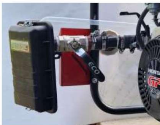
Valve (AFR) di Posisi #2 HAMPIR TERTUTUP untuk — "Gasura".
