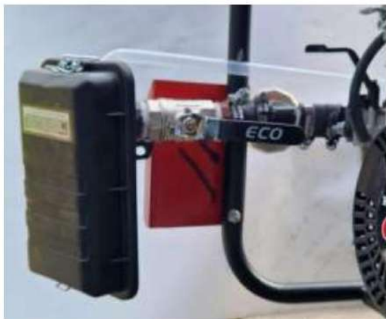
Katup (AFR) di Posisi #1 TERBUKA SEPENUHNYA untuk bensin.
