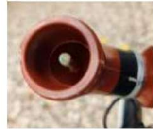
Pemandangan bohlam termometer di dalam kurva plastik.
