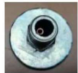
Nosel dilihat dari di dalam drum.
