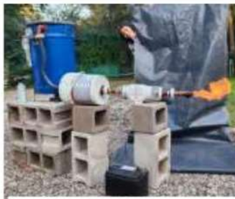
Membersihkan dan mengeluarkan udara dengan blower
