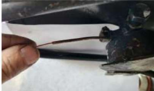
Masukkan probe melalui pipa tembaga dari LUAR ke DALAM.
