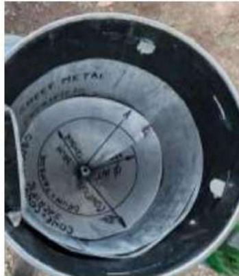
Lembar pelindung galvanis dan corong tahan karat non-magnetik
