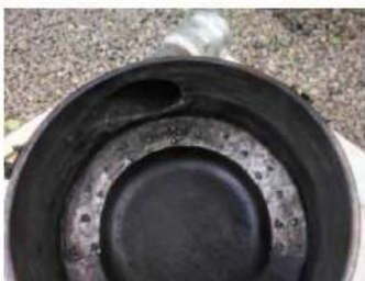
Lubang saluran masuk udara asli dipasang dan pipa saluran masuk tangensial baru dilas.
