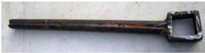
Batang pembersih nosel dengan slot untuk cerat air, yang berbentuk persegi untuk melonggarkan sumbat.
