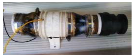
Ventilador tipo Bilge blower 12Vcc.
