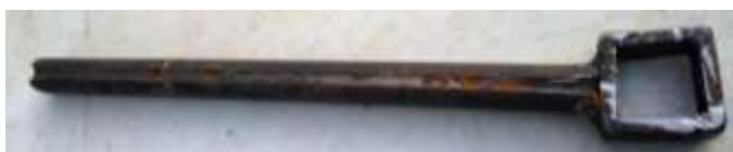
Barra de limpeza do bico com ranhura para a tubo de água, sendo a quadrada para soltar as tampas.
