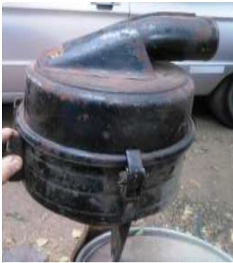
Filtro original, vista externa.
