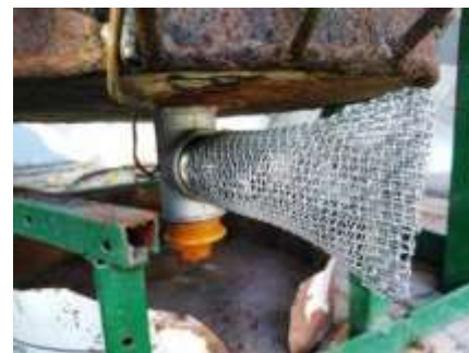
Corta-chamas na boca de ignição.
