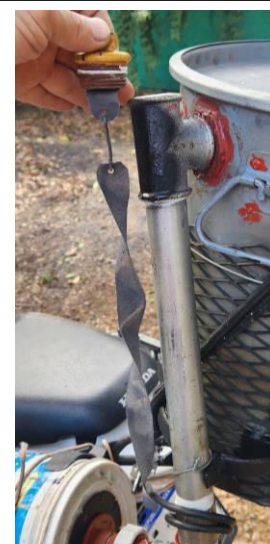
Chapa retorcida o serpentina colgando del tapón
