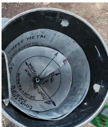
Chapa galvanizada de protección y cono de inoxidable no magnético
