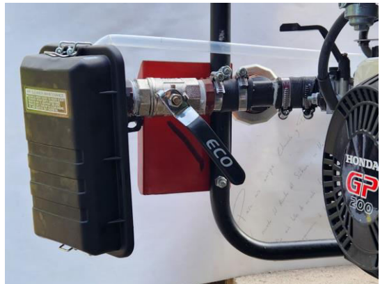
Válvula (AFR) en Posición #2 CASI CERRADA para “Gasura”.
