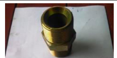
Enterrosca de manguera hidráulica NPT de 25.4mm. Diámetro interior: 20mm.
