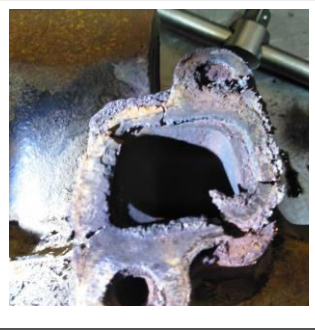
Junta corroída en el múltiple de escape.
